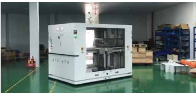
AMR NÂNG HẠ ĐIỀU HƯỚNG BẰNG LASER
