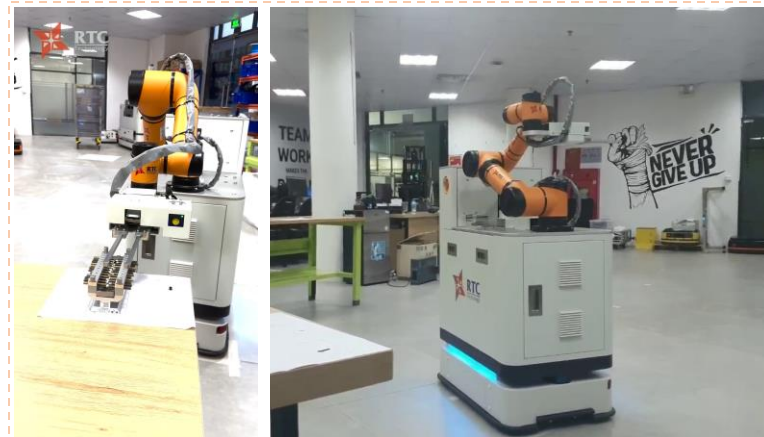
XE TỰ HÀNH KẾT HỢP VỚI ROBOT LASER AMR WITH COBOT
