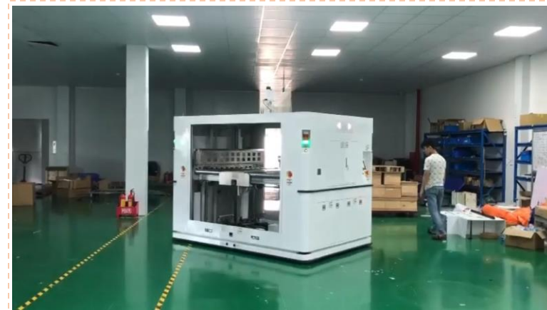
AGV NÂNG HẠ ĐIỀU HƯỚNG BẰNG LASER AGV LASER & LIFTING
