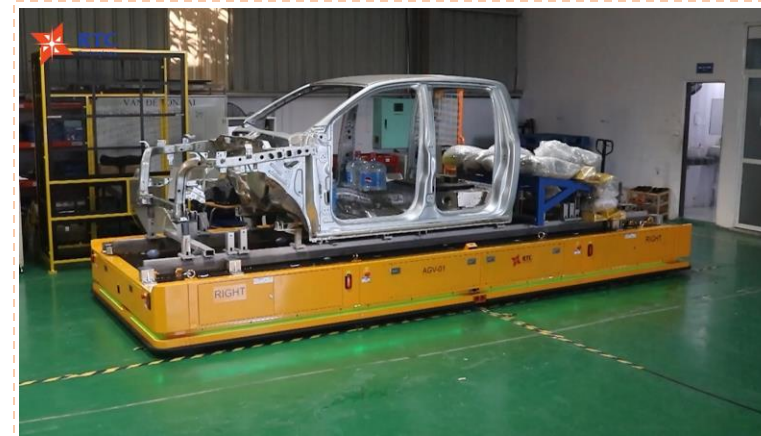
AGV NÂNG HẠ GẮM Ô TÔ HẠNG NẶNG LIFTING AND LOWERING THE UNDERCARRIAGE OF A HEAVY-DUTY TRUCK
