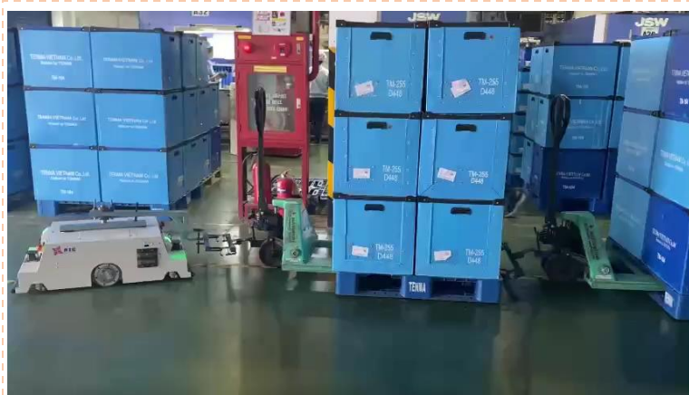
AGV KÉO VỚI KHOA ĐÓNG MỞ THỦ CÔNG AGV TOWING WITH MANUAL LOCK & UNLOCK
