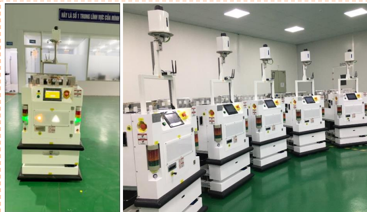
AGV KẾT HỢP BĂNG TẢI ĐIỀU HƯỚNG LASER AGV LASER & CONVEYOR
