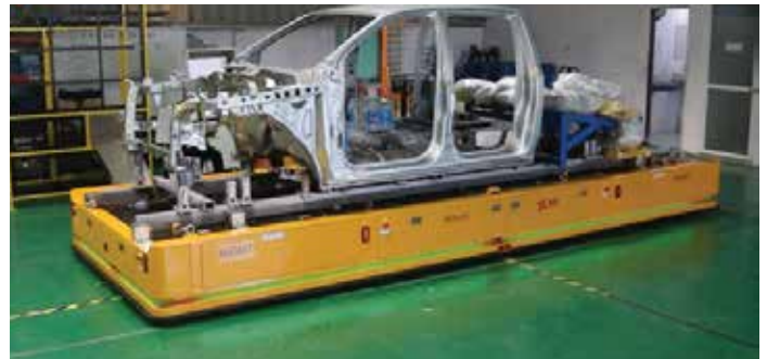
AGV NÂNG HẠ KHUNG GẦM Ô TÔ HẠNG NẶNG LIFTING AND LOWERING THE CHASSIS OF A HEAVY-DUTY TRUCK
