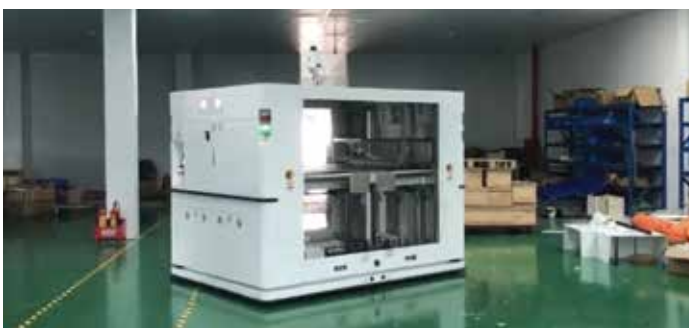
AMR NÂNG HẠ ĐIỀU HƯỚNG BẰNG LASER
